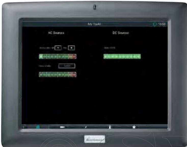
**Home Seite:** Statusübersicht der Stromquellen wie Landstrom, Inverter Generatoren und Batterien. Eine einfache Bedienung ist von hier möglich wie z.B. Ein/Aus Ihres Inverters.
