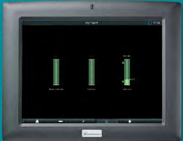
**Tankanzeigen Seite:** Mit allen Information von bis zu 10 Tanks. Voll- und Leerpegelalarme können gewählt und gesetzt werden. Alle Tankanzeigen, die mit dem MasterBus verbunden sind werden automatisch erkannt und dargestellt.
