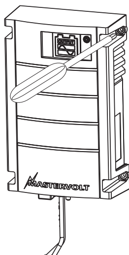
Afbeelding 8: Montage tegen de muur
