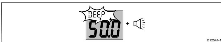
Alarme werden ausgelöst, wenn der eingerichtete Alarmgrenzwert überschritten wird. Alarme ertönen so lange, bis sie stummgeschaltet werden.
