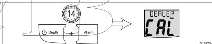
2. Drücken Sie gleichzeitig die Tasten **Offset** und **Reset**, um die Benutzerkalibrierungs-Zugriffsseite anzuzeigen.
