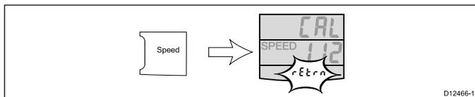
Das Wort RETURN blinkt am oberen Rand der Seite und die angezeigte Entfernung wird festgesetzt.
