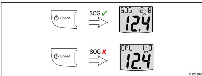
9. Drücken Sie gleichzeitig die Tasten **Timer** und **Reset**, um zwischen der Kalibrierfaktor- und der SOG-Seite zu wechseln.
