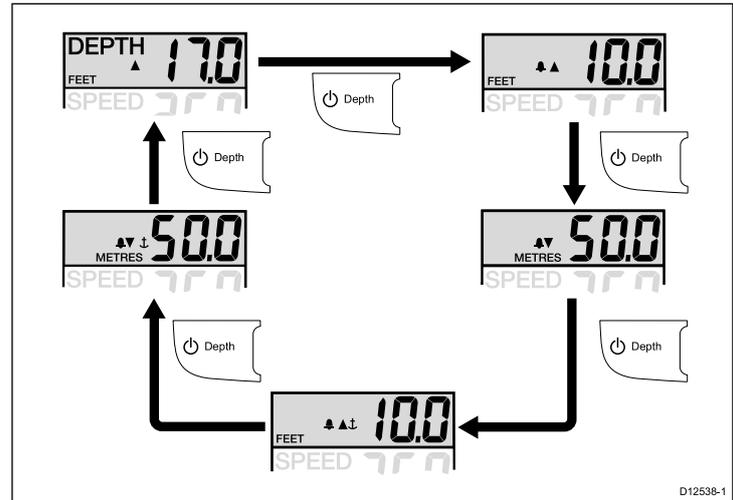
1. Verwenden Sie die Taste **Depth**, um die verfügbaren Tiefen-Seiten durchzugehen.
