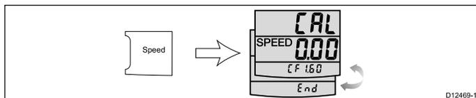
13. Sie können die Geschwindigkeitskalibrierung jederzeit verlassen, indem Sie die Tasten **Depth** und **Speed** gleichzeitig 4 Sekunden lang gedrückt halten.
