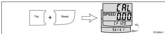
5. Beginnen Sie die Hinfahrt des Kalibrierungslaufs und drücken Sie die Taste **Speed**, wenn Sie den Startpunkt passieren. Am oberen Rand der Seite erscheint OUTWARD. Während des Kalibrierungslaufs wird der angezeigte Wert sich ändern.
