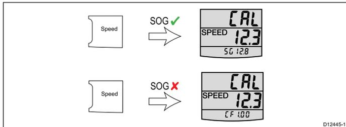
8. Drücken Sie gleichzeitig die Tasten **Trip** und **Reset**, um zwischen der Kalibrierfaktor- und der SOG-Seite zu wechseln.
