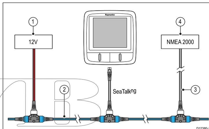
1. 12V-Gleichstromversorgung zum Backbone
