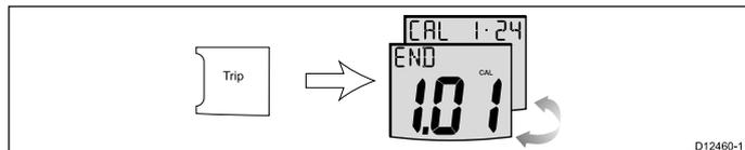
13. Sie können die Geschwindigkeitskalibrierung jederzeit verlassen, indem Sie die Tasten **Speed** und **Trip** gleichzeitig 4 Sekunden lang gedrückt halten.
