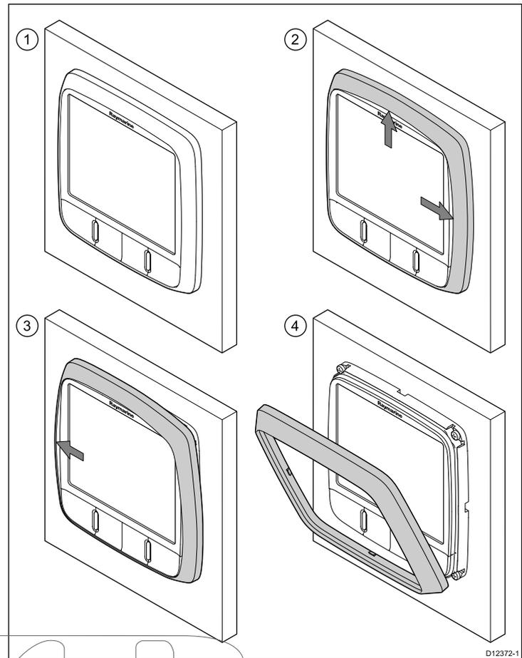
**Hinweis:** Gehen Sie vorsichtig vor, wenn Sie den Gehäuserahmen abnehmen. Verwenden Sie keine Werkzeuge, um den Gehäuserahmen abzuhebeln, da dieser dadurch beschädigt werden könnte.
