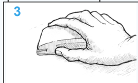
Figura 8 Carteggiare le superfici non porose. Creare un substrato su cui la resina epossidica possa fare presa.
