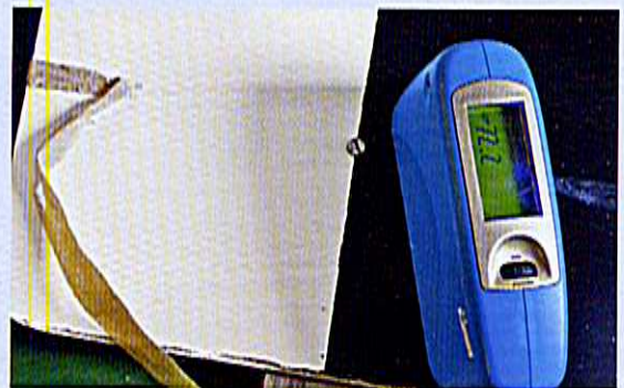
Der blaue Glossmeter wird auf die Fläche gestellt und misst dort im Bruchteil einer Sekunde
