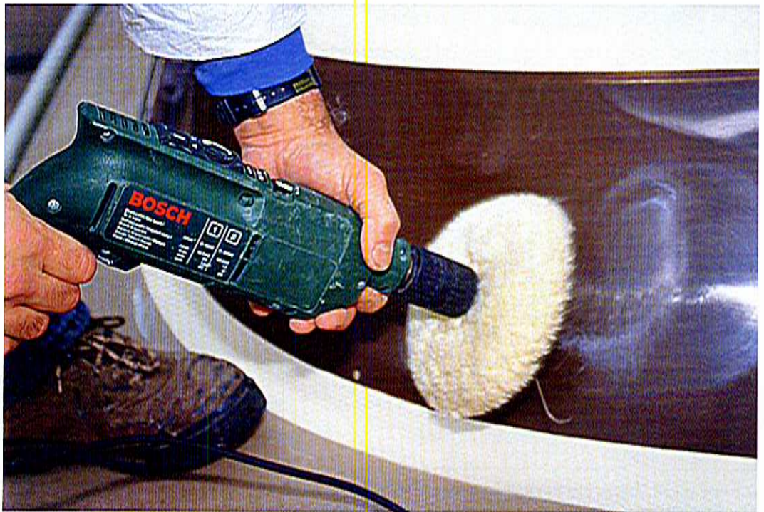
Spezialmaschinen sind für die Politur nicht unbedingt erforderlich, eine Bohrmaschine tut es auch
