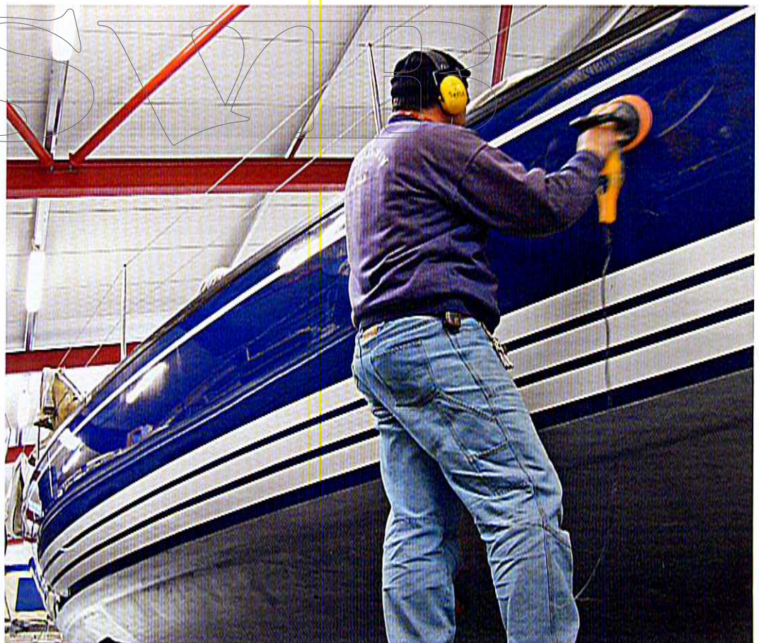
Wird die Poliermaschine kreuz und quer über den Bootsrumph geföhrt, entstehen die besten Ergebnisse
