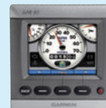
Témoin lumineux Eco Garmin/Honda indiquant que le moteur fonctionne en mode mélange pauvre.
