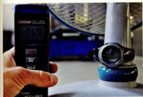
Anzeige des Temperatursensors im Wasser. Rechts im Bild der Ventilator und Zeitnahme
