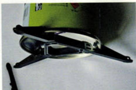
Doppelt so große Standfläche dank Nachrüstfuß mit anklappbaren Beinchen. Die Aussparungen in verschiedenen Radien erlauben die Benutzung für unterschiedlich große Kartuschen
