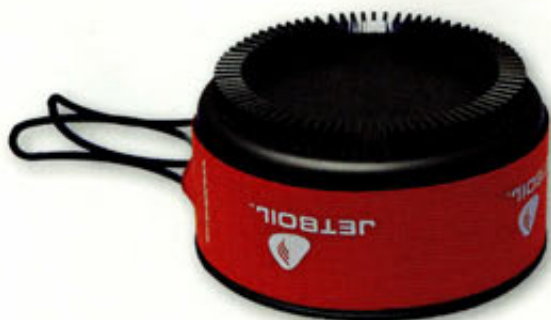
Wärmetauscher am Topf von Jetboil. Das umlaufende, gefaltete Blech vergrößert die Oberfläche und heizt dem Topf in der Peripherie kräftig ein
