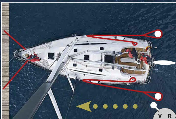
3 Wenn die Yacht steht, die Mittelsprings gleichzeitig fieren, mit Ruderlage und Schub die Yacht ausrichten. Vorleinen ausbringen.
