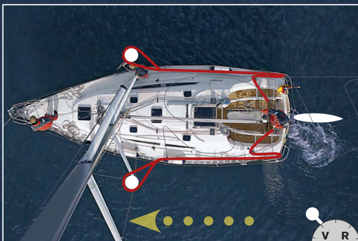
1 Sobald die Pfähle erreichbar sind, beide Mittelsprings festmachen. Die Yacht läuft währenddessen langsam in die Box.
