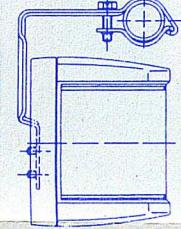
Positionslaternen können mit dem Halter „C“ an allen Anbauflächen angebracht werden, da er je nach Bedarf gebogen, gekürzt oder verdreht werden kann.
