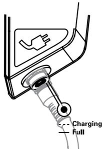
Die Ladebuchse des Akkus ist mit einem Stecker gekennzeichnet. Zum Laden wird das Netzteil mit Steckdose und Ladebuchse verbunden. Während des Ladevorganges blinkt die Ladekontroll-Leuchte (Charging) im Batteriegehäuse. Ist der Ladevorgang abgeschlossen, leuchtet diese Leuchte permanent. Für genauere Informationen kann während des Ladevorganges die Pinne mit dem Akku verbunden werden. In diesem Fall zeigt das Pinnen-Display die Funktion „Charging“ sowie den Ladestand in Prozent an.
