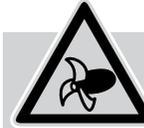
Die Auto-kick-up Einstellung schützt den Motor bei Grundberührungen. Sie bietet keine Gewähr, dass eine Grundberührung nicht zu Schäden am Propeller oder sogar am Motor führt. Dies gilt insbesondere für Grundberührungen auf Stein oder Fels.
