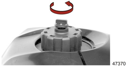
5. Portare il rubinetto di arresto del combustibile in posizione "ON" (Apertura).
