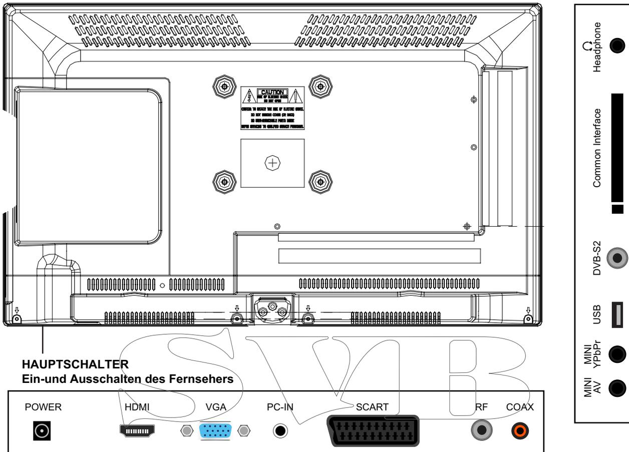
**POWER:** An das Netzteil anschließen.
