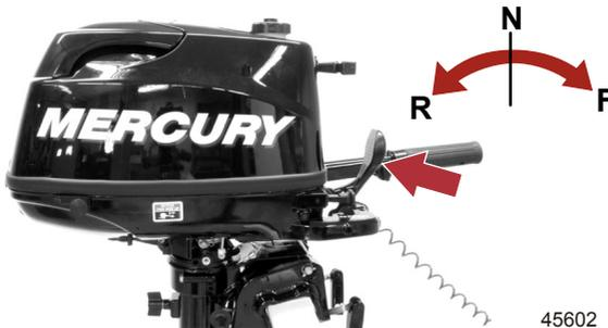
**NOTA:** Il motore si avvia solo se il cavo salvavita è innestato nell'interruttore di arresto.
