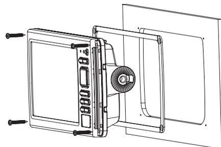
16 Setzen Sie das Gerät und die Halterung in den Ausschnitt ein.
