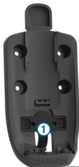
2 Poleđinu uređaja poravnajte s urezima na nosaču i uređaj pomičite prema dolje dok ne sjedne na mjesto.
