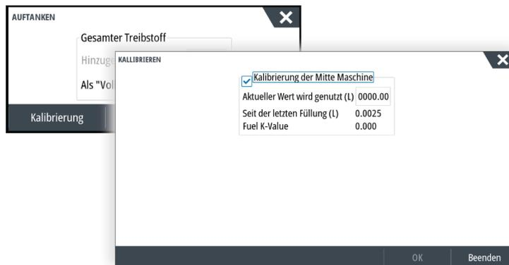
1. Beginnen Sie mit vollem Tank, und lassen Sie den Motor wie im Normalbetrieb laufen.
