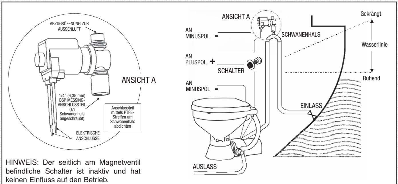
**HINWEIS:** Der seitlich am Magnetventil befindliche Schalter ist inaktiv und hat keinen Einfluss auf den Betrieb.
