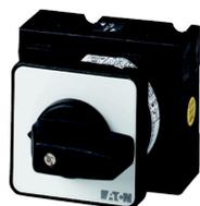
Umschalter, T3, 32 A, Einbau, 1 Baueinheit(en), Kontakte: 2, 60 °, rastend, mit 0-Stellung, 1-0-2, Abwicklungs Nr. 8210
