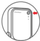
1. Schalten Sie die Basisstation ein, indem Sie die Einschalttaste 3 Sekunden lang gedrückt halten.
