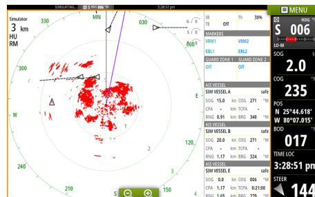
AIS-fartøy på et radarpanel
