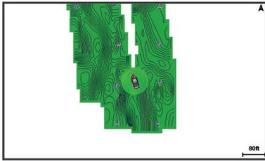
Ein grüner Kreis kennzeichnet eine gute Tiefe und GPS-Position und eine Geschwindigkeit unter 16 km/h (10 mph). Ein gelber Kreis kennzeichnet eine gute Tiefe und GPS-Position und eine Geschwindigkeit zwischen 16 und 32 km/h (10 und 20 mph). Ein roter Kreis kennzeichnet eine schlechte Tiefe oder GPS-Position und eine Geschwindigkeit über 32 km/h (20 mph).
