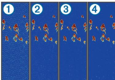
Wenn Sie die Störungseinstellung von „Aus“ ① über „Niedrig“ ②, „Mittel“ ③ und „Hoch“ ④ anpassen, werden Störungen schrittweise entfernt. Die starken Echolotsignale werden dadurch aber kaum beeinflusst. Sie sollten die niedrigste Störungseinstellung verwenden, bei der die gewünschte Verbesserung erzielt wird, um Störungen vom Bildschirm zu entfernen. Störungen lassen sich am besten vermeiden, indem montagebedingte Probleme beseitigt werden, die Störungen verursachen.
