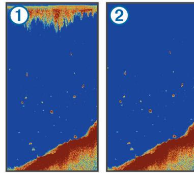
Oberflächenstörungen ① entstehen durch Störungen zwischen dem Geber und dem Wasser. Sie können Oberflächenstörungen ausblenden ②, um Seegangsstörungen zu verringern. Bei breiteren Kegeln (niedrige Frequenzen) können mehr Ziele angezeigt werden, allerdings werden u. U. auch mehr Oberflächenstörungen erzeugt.
