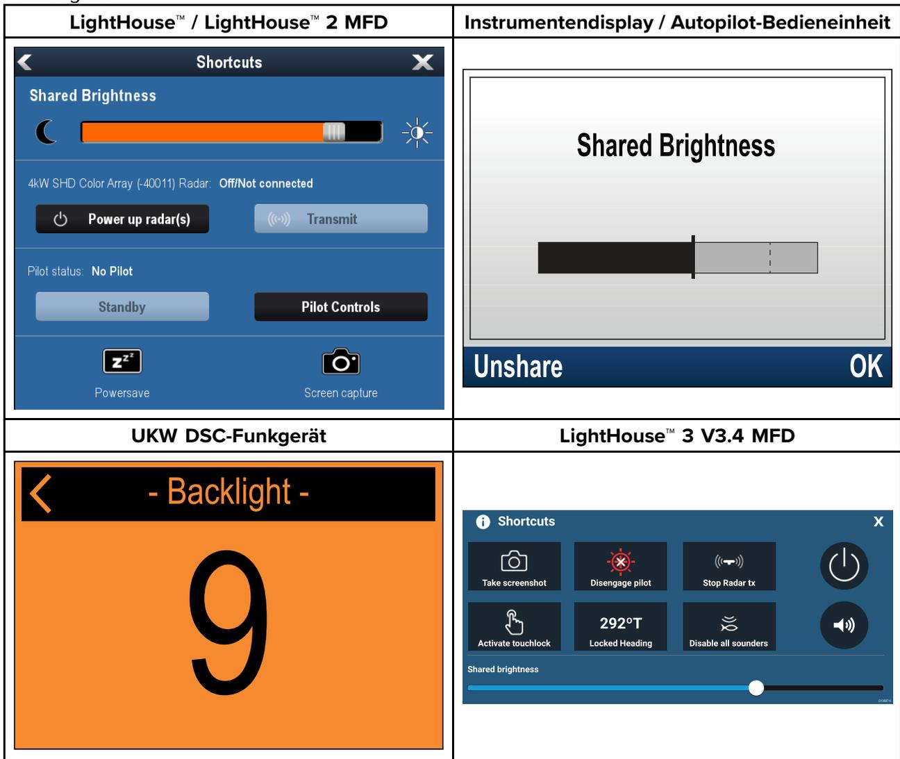
Sie können mehrere Helligkeitsgruppen einrichten, die den physischen Standort der Geräte auf dem Schiff widerspiegeln. Beispielsweise könnten Sie alle Geräte auf dem Steuerstand in einer Gruppe zusammenfassen und die Geräte auf der Flybridge in einer anderen.
