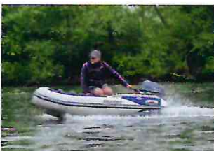
Gute Gleitfahrt mit 21,2 Stundenkilometern. Etwas seitliche Drift in der Kurve
