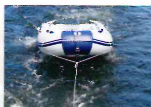
Mit 6,9 Kilogramm hoher, aber nicht der höchste Widerstand. Sehr guter Nachlauf
