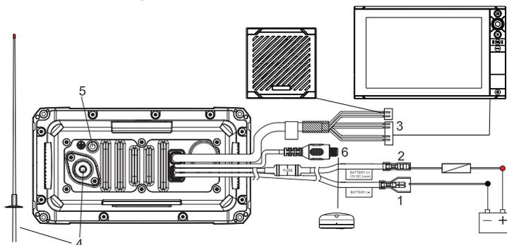
1. Batería - (negro): conectar a la barra colectora de negativo del barco
