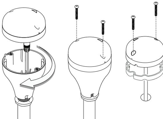
Para **montar en un poste** la antena GPS-500 externa, necesitará un poste de rosca de 1 pulgada 14 PPI:
