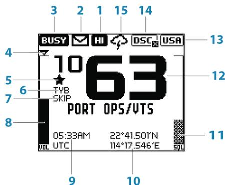
1. El canal está configurado para transmisión de alta potencia
