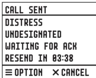
La llamada de socorro se reenviará automáticamente en intervalos de 3,5 a 4,5 minutos hasta que se reciba una confirmación de la llamada de socorro.
