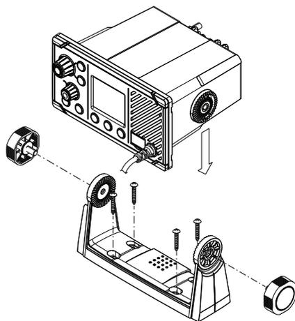
1. Sujete el soporte en la ubicación elegida y use un lápiz para marcar las posiciones de los orificios para los tornillos en la superficie de montaje.
