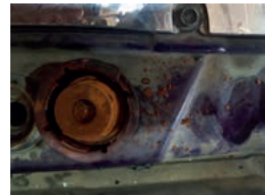
Korrosionsablagerungen im Ausgleichsbehälter und im Verschluss.
