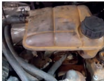
Korrosionsablagerungen im Ausgleichsbehälter und im Verschluss.
