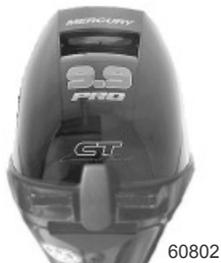
2. Lever l'avant du capot pour dégager le verrouillage avant et le pousser vers l'arrière pour dégager le crochet arrière.
