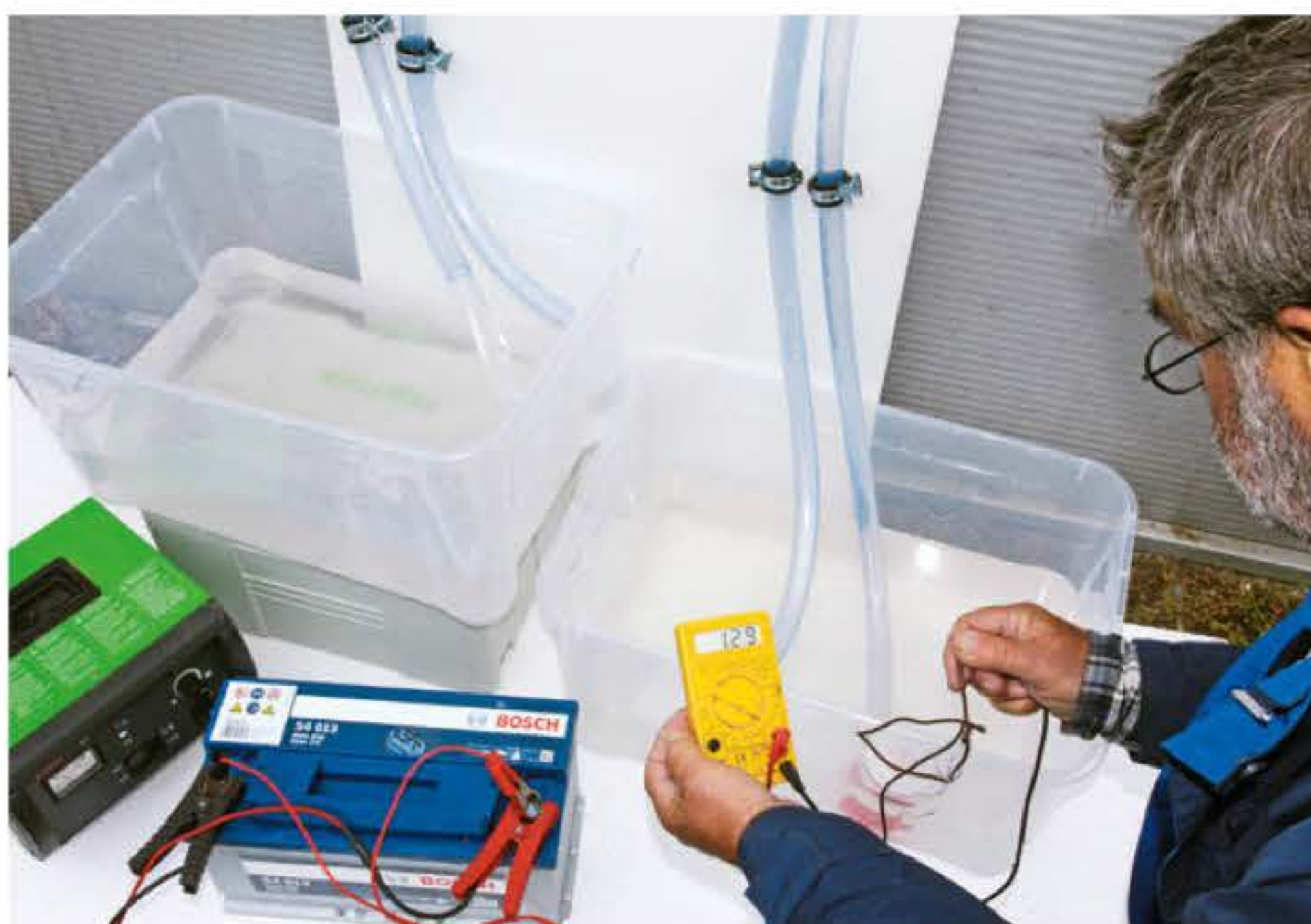
Für die Energieversorgung sorgte während der Testläufe ein 100-Ah-Akku, wie er auch auf kleinen Booten eingesetzt wird. Strom und Spannung ermittelten wir per Multimeter
