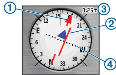
L'indicatore di percorso ① indica la posizione in relazione a una linea di percorso che conduce alla destinazione. L'indicatore di deviazione (CDI) ② fornisce l'indicazione di deviazione (destra o sinistra) dal percorso. La scala ③ si riferisce alla distanza tra i punti ④ sull'indicatore di deviazione, che indica la distanza dal percorso.
