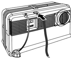
1. Inserire il tubo del gas di scarico isolato.
