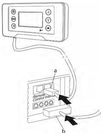
1. Inserire la spina del cavo dati (1) nella presa "Remote Control" della cella a combustibile EFOY COMFORT.
