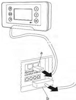
1. Estrarre il cavo di alimentazione (2) e il cavo dati (1) per il pannello di comando dalla cella a combustibile EFOY COMFORT.
