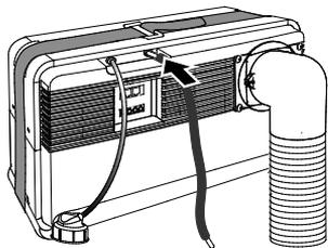
6. Inserire nuovamente il tubo del gas di scarico.
