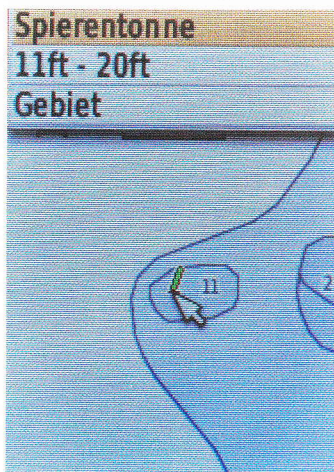
Besondere Punkte auf der Seekarte, wie hier die Tonne, werden bei dem Garmin „78s“ auf Knopfdruck erklärt
