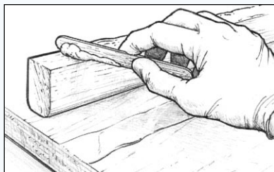
Figura 10 Aplique epoxi espesado a una de las superficies a unir.
