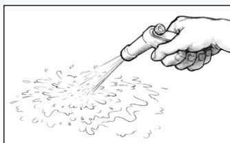
Figura 33 Enjuague la superficie con agua fresca después de lijar.
