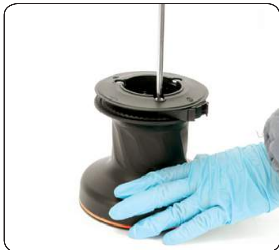
I. Unscrew the 3 screws n°16 ( \approx 4\text{Nm}/35\text{ in-lb} )
