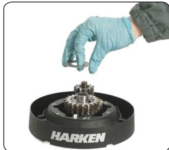
11. Remove the washer n°14
