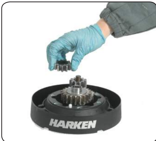
10. Remove the gear n°15
