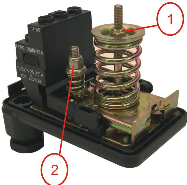
**MODALITA' DI TARATURA.** Per modificare la taratura standard di fabbrica bisogna operare sul dado rif.(1) per variare la pressione di avvio della pompa (minimo 0,6 bar) e sul dado rif.(2) per variare la pressione di stacco della pompa (max 3,0 bar). Avvitando il dado di regolazione in senso orario si incrementano i valori di taratura. Non operare al di fuori di questi due campi di intervento.
