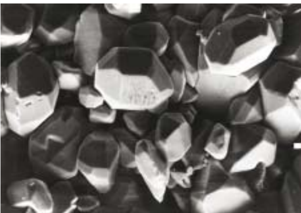
Plattenoberfläche nach zwei Jahren ohne Pulsung. Überwiegend kristallines Sulfat, starker Kapazitätsverlust.
