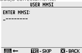
→ **Nota:** El MMSI solo puede introducirse una vez. Para cambiar el MMSI, tendrá que devolver la radio a un distribuidor Simrad/B&G.
