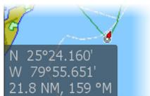
Se il cursore è attivo, viene visualizzata la finestra della posizione. Quando il cursore è attivo, il riquadro non si sposta né ruota per seguire l'imbarcazione.
