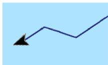
Le tracce sono la rappresentazione grafica del tratto percorso in passato dall'imbarcazione. Permettono di ricostruire il percorso dell'imbarcazione. Le tracce possono essere convertite in rotte dalla finestra di dialogo Modifica.
