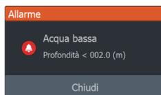
Un singolo allarme viene visualizzato con il nome dell'allarme nel titolo e con i dettagli correlati.
