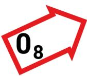
Die dynamische Strömungsgrafik ist ein Pfeil, der in Richtung der aktuellen Strömung deutet. Die Länge des Pfeils zeigt dabei die Geschwindigkeit der Strömung an, d. h. je länger der Pfeil, desto größer die Strömungsgeschwindigkeit. Der Rand des Pfeils zeigt den Strömungsstatus an:
