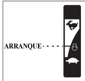
4. Alinee la marca " ⚙ " en la empuñadura del acelerador con el extremo proyectado de la marca " ▶ " de la caña.
