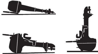
Apoye el motor fuera borda encima de los protectores de la caja. (Con el lado de la caña del timón del motor fueraborda hacia arriba)
