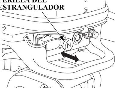
Cuando el motor está frío tire de la perilla de estrangulación para arrancar con facilidad. Cuando se tira de la perilla del estrangulador se suministra una mezcla de combustible rica al motor.
