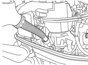
3. Rellene aceite del recomendado hasta la marca de nivel superior de la varilla de medición del nivel de aceite. Inserte la varilla de medición enroscándola, extráigala y compruebe el nivel de aceite indicado en la varilla.
