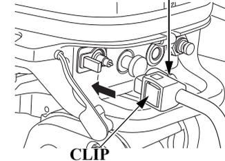
1. Mientras presiona el retenedor del conector de la línea de combustible, tire del conector de la línea de combustible y desconéctelo de la junta del lado del motor fueraborda e instale la tapa de entrada de combustible.
