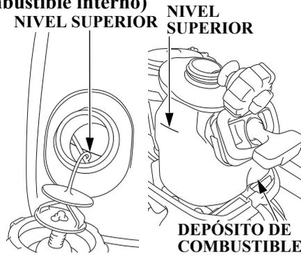
Abra la perilla de ventilación de la tapa de relleno de combustible (consulte la página 23). Extraiga la tapa de relleno de combustible y compruebe el nivel del combustible. Llene el depósito si el nivel del combustible es bajo.
