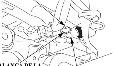
**PALANCA DE LA VÁLVULA DE COMBUSTIBLE**
