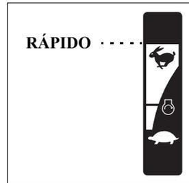
1. Con la palanca de cambios en la posición de AVANCE, gire la empuñadura del acelerador en el sentido de RÁPIDO para aumentar la velocidad.
