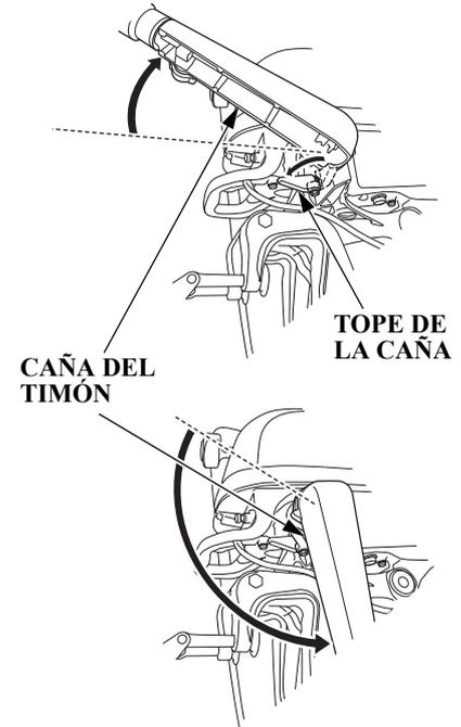
La caña del timón se puede mover hacia la dirección inferior girando el tope de la caña.
