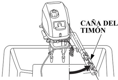
2. Retire la banda del cable tirando de su lengüeta en la dirección indicada, y retire la banda del cable.
