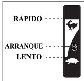
Gire la empuñadura del acelerador a la derecha o a la izquierda para ajustar la velocidad del motor. Al girar la empuñadura del acelerador en la dirección indicada por la flecha se incrementa la velocidad del motor.
