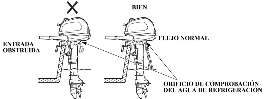
8. Después de haber arrancado, compruebe si circula agua de refrigeración por el orificio de comprobación del agua de enfriamiento. La cantidad de circulación de agua de enfriamiento por el orificio de comprobación puede variar debido a la operación del termostato, pero esto es normal.
