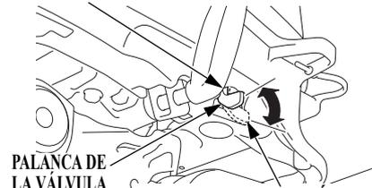
PALANCA DE LA VÁLVULA DE COMBUSTIBLE
