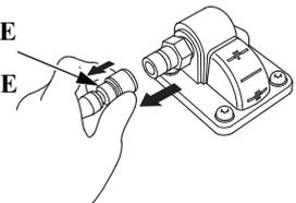
2. Mientras tira de la cubierta del conector de la línea de combustible, tire del conector de la línea de combustible para desconectarlo del depósito de combustible portátil.
