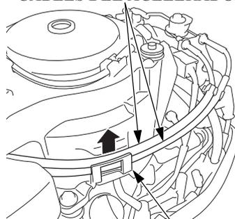
3. Suelte los cables del acelerador del gancho de la cubierta.
