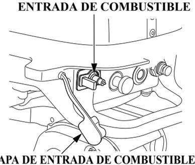
Extraiga la tapa de entrada de combustible y conecte el conector de la línea de combustible a la entrada de combustible cuando utilice el depósito de combustible portátil. Instale siempre la tapa de entrada de combustible si el conector de la línea de combustible no está conectado. Asegúrese de que la tapa de entrada de combustible está instalada de forma segura.
