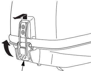
ENGANCHE DE LA CUBIERTA DEL MOTOR
