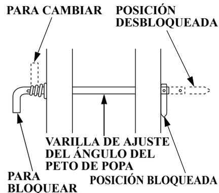
2. Insertando la varilla de ajuste del ángulo del peto de popa en el orificio apropiado, enrósquela por abajo para bloquearla. Después de haberla bloqueado, tire de la varilla de ajuste del ángulo del peto de popa para asegurarse de que no se sale.
