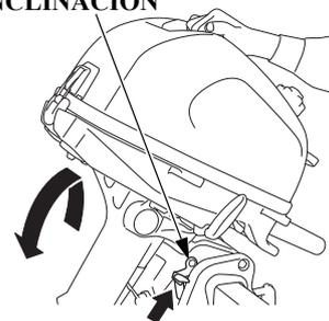
6. Ponga la palanca de inclinación en la posición "INCLINACIÓN" y eleve el motor fueraborda hacia una posición de inclinación de 18°, 34° o 58°.
