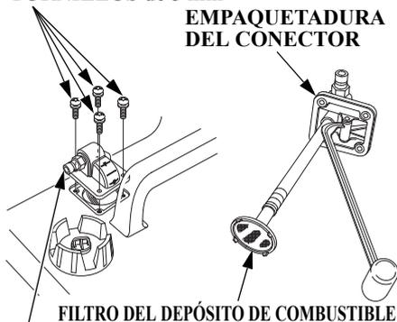
UNIÓN DEL FILTRO DEL DEPÓSITO DE
