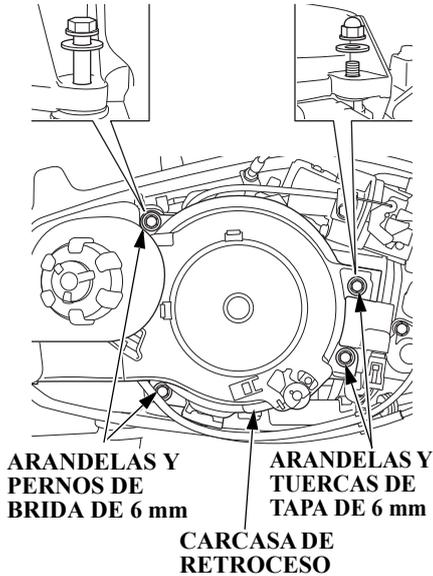
6. Extraiga las dos tuercas de tapa de 6 mm, las dos arandelas, los dos pernos de brida de 6 mm y las dos arandelas. Extraiga la carcasa de retroceso.
