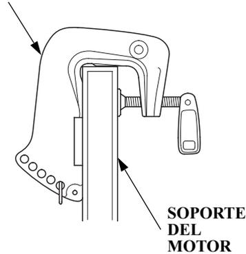
1. Fije las ménsulas de popa a un soporte para motores y monte el motor fuera borda en las ménsulas.
