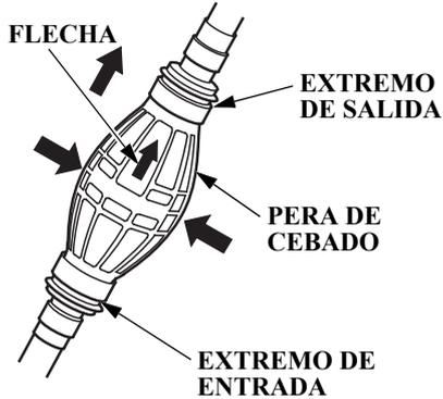
La manguera de combustible que conecta el depósito de combustible portátil al motor fuera borda lleva incorporada una pera de cebado.
