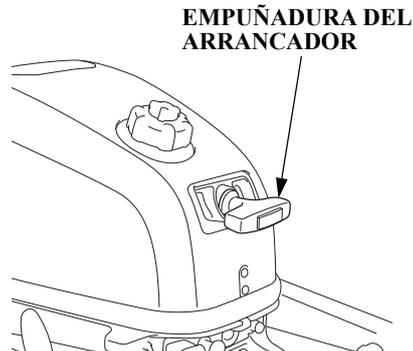
Al tirar de la empuñadura del arrancador se acciona el arrancador de retroceso para virar y poner en marcha el motor. Ponga la palanca de cambios en la posición NEUTRAL (punto muerto) antes de arrancar.
