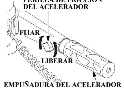
La perilla de fricción del acelerador ajusta la resistencia a la rotación de la empuñadura del acelerador. Gire la perilla de fricción del acelerador hacia la derecha para incrementar la fricción con el propósito de retener un ajuste del acelerador durante la navegación. Gire la perilla de fricción del acelerador hacia la izquierda para reducir la fricción y facilitar así la rotación de la empuñadura del acelerador.
