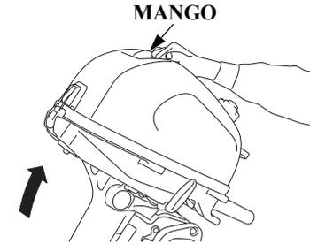
5. Mueva la palanca de inclinación a la posición "INCLINACIÓN". Sujete la empuñadura de la tapa del motor y eleve el motor fueraborda.
