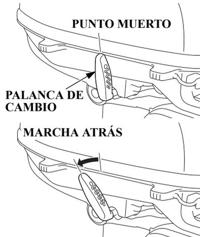
Utilice la palanca de cambios para hacer marchar la embarcación hacia adelante o hacia atrás, o para cortar la potencia del motor a la hélice. La palanca de cambios tiene tres posiciones. Se puede tirar de la cuerda del arrancador para arrancar el motor con la palanca de cambios en la posición de PUNTO MUERTO.
