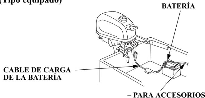
El cable de carga de la batería proporciona una salida de 12 voltios y 6 amperios para cargar baterías. El circuito de carga está protegido por un fusible de 15 amperios que está conectado al cable de carga de la batería.
