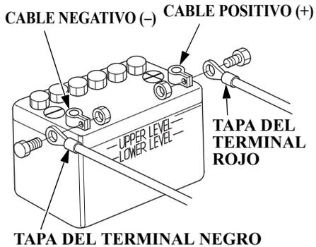
1. Desconecte el cable de la batería en el terminal negativo (-) y luego en el terminal positivo (+).
