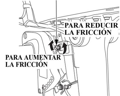
El perno de fricción de la dirección ajusta la resistencia de la dirección.
