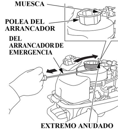
15. Coloque el extremo anudado de la cuerda del arrancador de emergencia (se entrega con el motor) en la muesca de la polea del arrancador mientras tira de la cuerda del arrancador de emergencia hacia la derecha alrededor de la polea del arrancador.
