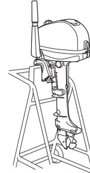
2. Mueva la palanca de cambios a la posición REVERSE y bloquee la palanca de inclinación.
