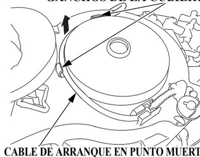
4. Suelte el cable de arranque en punto muerto de los ganchos de la cubierta.
