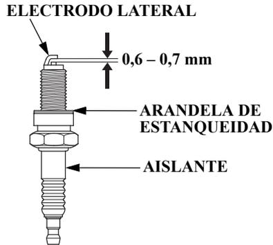
5. Mida el huelgo de la bujía con un calibre de espesores. El huelgo deberá ser de 0,6 - 0,7 mm. Corrija si es necesario doblando con cuidado el electrodo lateral.
