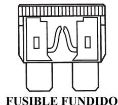
Si se funde el fusible, la batería no se cargará aunque funcione el motor.
