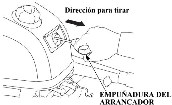
6. Tire ligeramente de la empuñadura del arrancador hasta notar resistencia, y entonces tire con fuerza en la dirección de la flecha como se muestra arriba.
