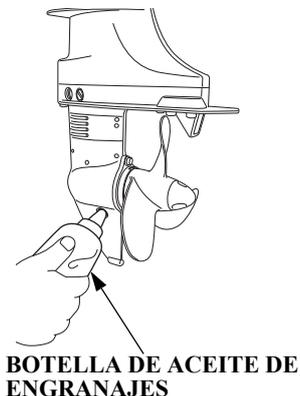
2. Deje que el aceite usado se drene completamente, y después instale un adaptador de bomba de aceite en el orificio de drenaje del aceite. Si sale agua o aceite contaminado (color lechoso) por el orificio de drenaje cuando quite el tapón, pida a un concesionario autorizado Honda Marine que revise el motor fueraborda.
