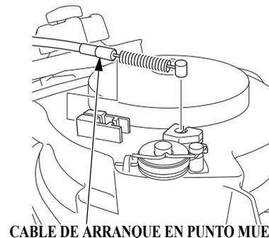
5. Desconecte el cable de arranque en punto muerto de la carcasa de retroceso.
