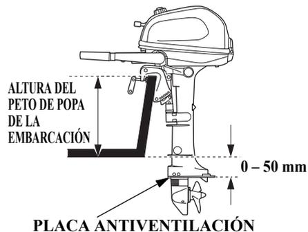
La placa antiventilación del motor fueraborda debe quedar de 0 a 50 mm por debajo de la parte inferior de la embarcación.
