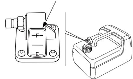
El indicador de combustible indica el nivel de combustible en el depósito. Cuando tenga que llenar el depósito de combustible, gire la perilla de ventilación de la tapa de relleno de combustible hacia la izquierda para abrir y quitar la tapa de relleno de combustible.
