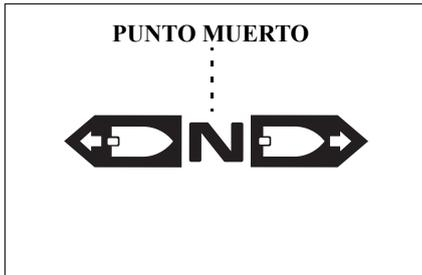
3. Mueva la palanca de cambios a la posición de PUNTO MUERTO. El arrancador de retroceso no podrá accionarse a menos que la palanca de cambios esté colocada en la posición NEUTRAL.
