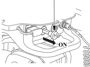
13. Cuando el motor está frío o la temperatura ambiental es baja, tire de la perilla del estrangulador a la posición ON.
