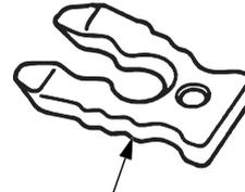
1. Acople el retenedor del interruptor de parada de emergencia en un extremo del acollador del interruptor de parada de emergencia en el interruptor de parada de emergencia. Fije con seguridad el otro extremo del acollador del interruptor de parada de emergencia al operador.
