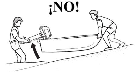
Transporte el motor entre más de dos personas. Para transportarlo, agarre el motor fueraborda por el asa de transporte, o agárrelo por el asa de transporte y cubierta inferior del motor, como aquí se muestra. No lo transporte agarrándolo por la cubierta del motor.
