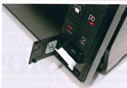
Karte auf der Vorderseite ist der Standard bei allen anderen Geräten. Den doppelten Aufwand mit Gummikappe und Klappe gibt es nur beim Axiom Pro
