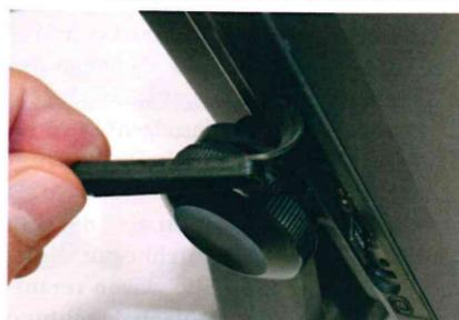
Furuno setzt die Kartenschächte an die Seite. Durch die leicht nach vorn angewinkelte Führung lassen sich die Chips auch bei Schottmontage noch gut greifen
