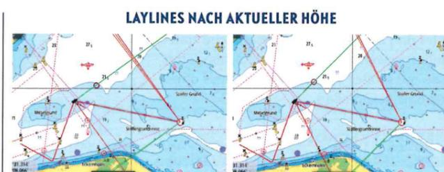
Werte nach aktuell gesegelter Höhe liefern eine Echtzeit-Prognose des Weges zum Ziel. Knüppeln Sie Höhe, wird der Wendewinkel kleiner und der Kurs kürzer (rechts). Steuern Sie voller, dann ist der Wendewinkel größer und die Strecke länger (links)
