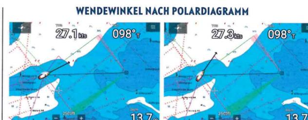
Hier wird berücksichtigt, was Ihr Schiff bei der aktuellen Windsituation tatsächlich leisten könnte. Angezeigt wird der Kurs für die nach Diagramm optimale Leistung. Ob Sie höher (links) oder tiefer (rechts) steuern, hat keinen unmittelbaren Einfluss auf die Anzeige
