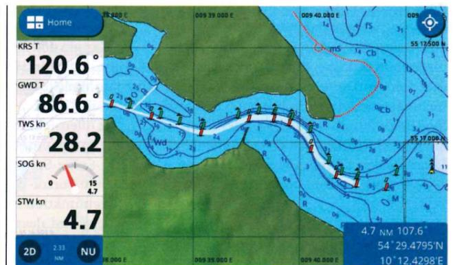
**RELIEF-SHADING** hebt die Höhen an Land hervor und zeigt damit, wo die Aussicht auf geschützte Buchten besteht – oder auf Fallwinde
