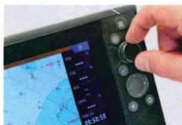
Der Zeuss trennt Cursorfeld und Drehknopf. Die Steuerad-Taste links darüber lässt sich mit zwei eigenen Funktionen belegen
