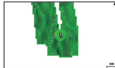
Ein grüner Kreis kennzeichnet eine gute Tiefe und GPS-Position und eine Geschwindigkeit unter 16 km/h (10 mph). Ein gelber Kreis kennzeichnet eine gute Tiefe und GPS-Position und eine Geschwindigkeit zwischen 16 und 32 km/h (10 und 20 mph). Ein roter Kreis kennzeichnet eine schlechte Tiefe und GPS-Position und eine Geschwindigkeit über 32 km/h (20 mph).
