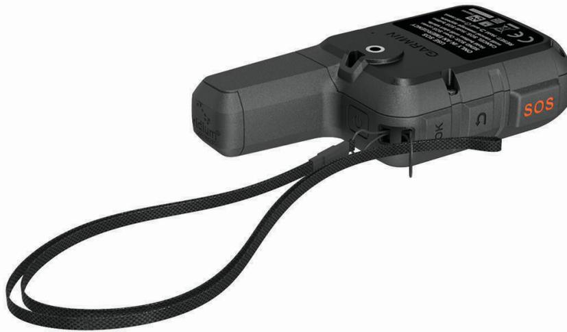
2 Faites passer l'autre extrémité du cordon à travers la boucle, puis serrez.
