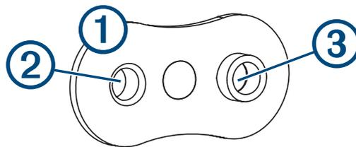
El otro orificio ③ de la placa de tuerca debe alinearse con el orificio interno de 4 mm ( $\frac{5}{32}$  in) de la plantilla.
