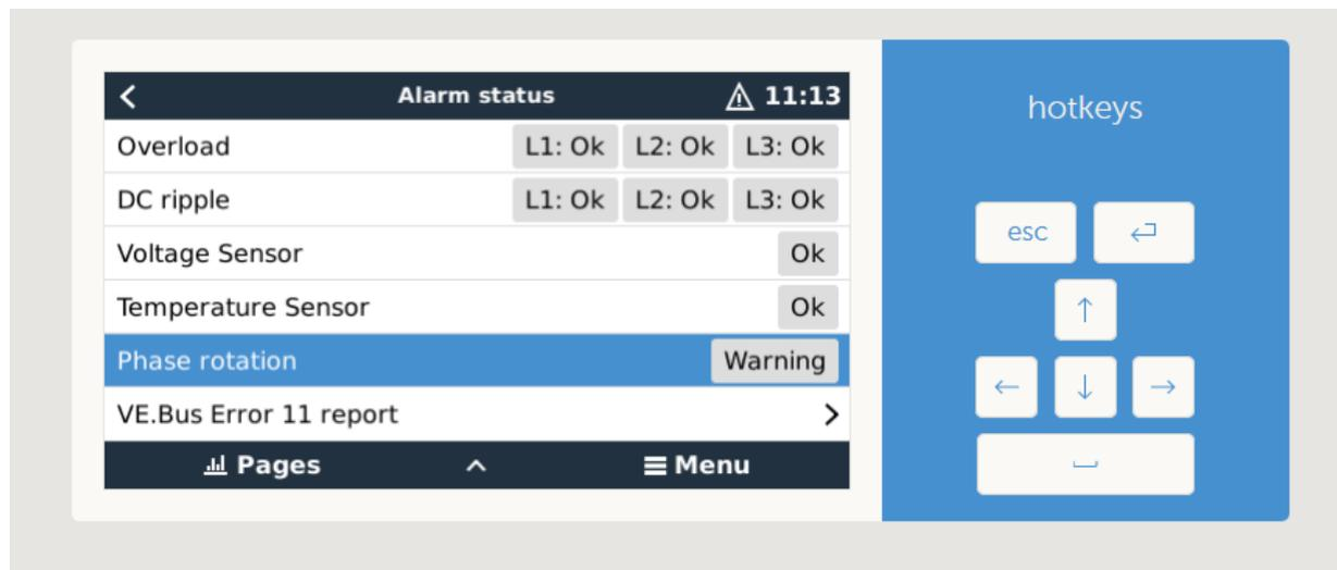
Et sur le portail VRM, il sera visible sur le widget Alarmes et avertissements VE.Bus, sur la page Avancé :
