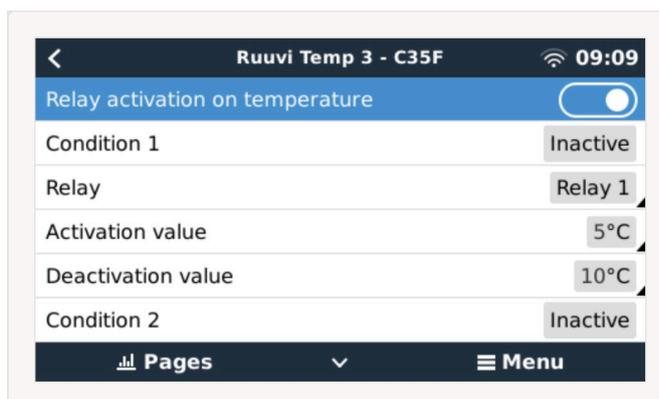
Si cela ne suffit pas à maintenir la température de la batterie au-dessus de 5 degrés, vous pouvez également connecter un deuxième contacteur de coussin chauffant au relais 2.
