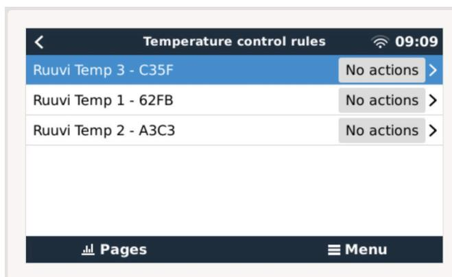
Pour les produits GX où deux relais sont disponibles (Cerbo GX), il est possible qu'un seul capteur de température contrôle les deux relais. Il est également possible d'avoir un seul relais contrôlé par plusieurs capteurs de température différents.
