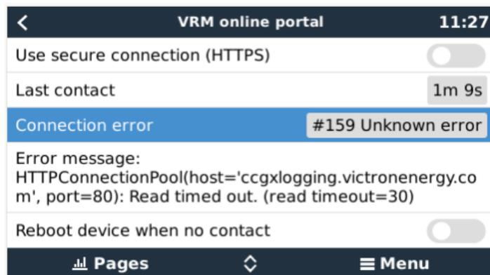
Vérifiez l'indication de « Dernier contact ». Si des tirets sont affichés, cela signifie que le périphérique GX n'a pas été en mesure de contacter le portail VRM depuis la mise sous tension. Si une heure est affichée mais qu'un état d'erreur est toujours visible, cela signifie que le périphérique GX a pu envoyer des données, mais a perdu le contact ensuite.
