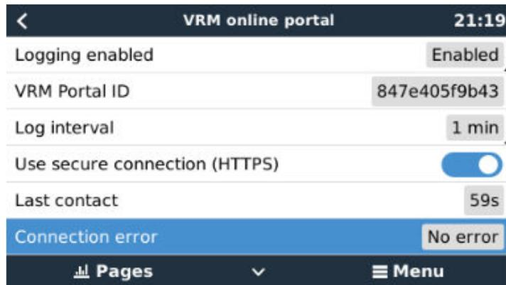
Si une erreur de connexion s'affiche, le CCGX ne peut pas contacter la base de données VRM. L'erreur de connexion affichera un code d'erreur indiquant la nature du problème de connectivité. De plus, les détails du message d'erreur s'affichent pour faciliter le diagnostic du problème par un technicien en informatique.
