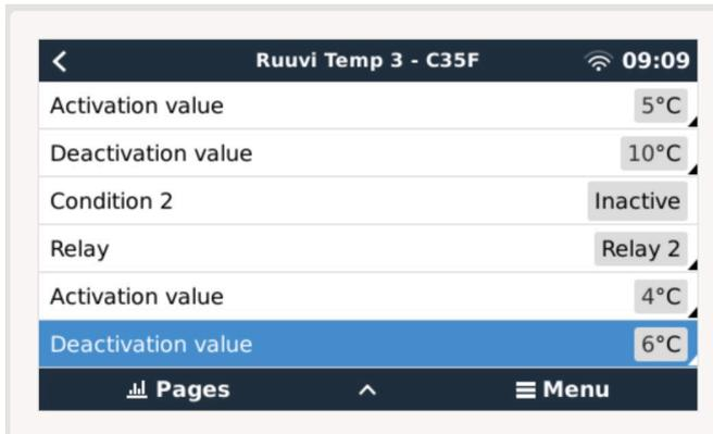
Cela signifie que le relais 1 sera activé si la température de la batterie tombe à 5 degrés. Si la température continue à chuter en dessous de 5 degrés jusqu'à atteindre 4 degrés, le deuxième coussin chauffant sera activé via le relais 2.
