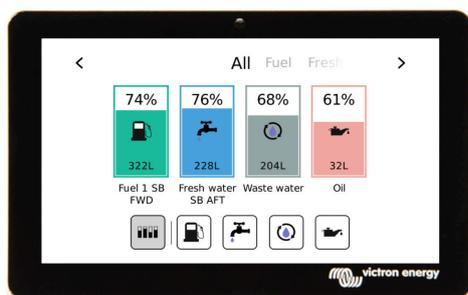
Le GX Tank 140 est compatible avec les émetteurs de courant (4 à 20 mA) ainsi que les émetteurs de tension (0 à 10 V). La connexion au dispositif GX se fait via USB, ce qui est également la façon dont le GX Tank est alimenté : aucun fil d'alimentation supplémentaire n'est nécessaire.
