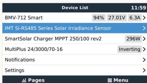
Dans le menu « Capteur d'irradiance solaire IMT de la série Si-RS485 », tous les paramètres disponibles s'afficheront automatiquement (en fonction des capteurs connectés) et seront mis à jour en temps réel.
