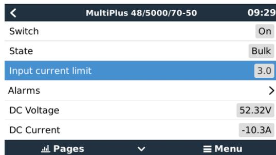
La limite telle que définie par l'utilisateur dans le CCGX sera appliquée à toutes les entrées où « renverser par la commande à distance » est activé, configuré avec VictronConnect ou VEConfigure :
