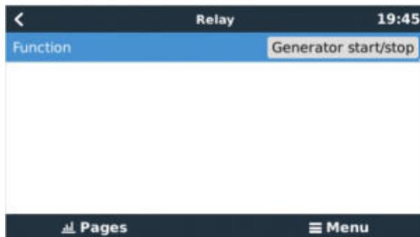
Ora che è stata attivata, tutte le impostazioni della funzione Avvio/Arresto Automatico del Generatore appaiono nel Menu principale: Impostazioni - Avvio/arresto del generatore.
