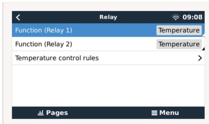
Ogni sensore di temperatura può essere utilizzato per controllare il relè.
